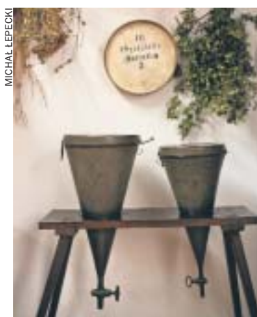
Perkolator - urządzenie do otrzymywania wyciągu z ziół
